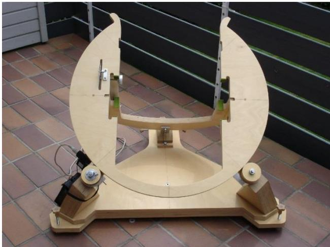
Abb. 5: 2 Holzrollen bilden das *Nordlager* der Polachse
