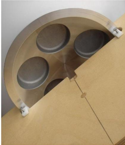
Abb. 9: U-förmige Abstandshalter stützen die Höhenräder seitlich ab.
