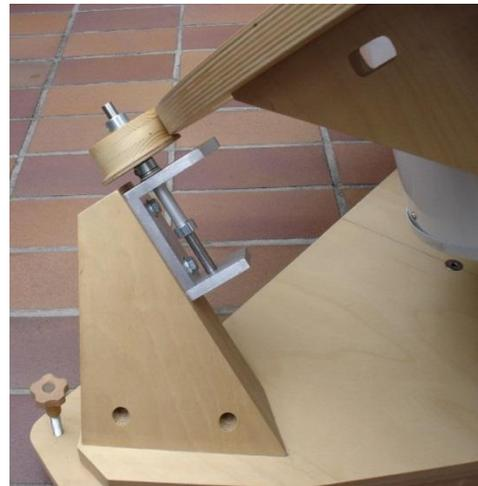
Abb. 6: Stützlager mit Rolle und Stütze
