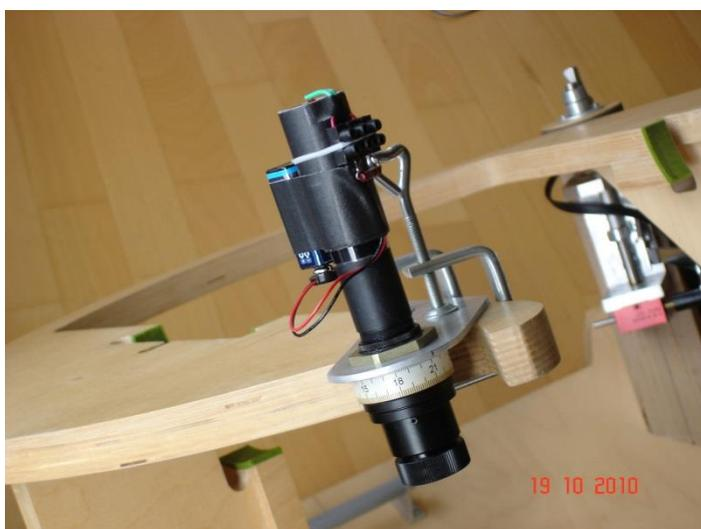
Polsucher auf einen Winkel  $58 \times 22 \times 750$  mm aus 2 mm dickem Alublech montiert und am Hufeisen entsprechend festgeklemmt. Dadurch kommt das Okular in eine Höhe, die einen bequemeren Einblick erlaubt (ist nicht abgebildet). Neuerdings gibt es im Handel auch Zenitspiegel für Polsucher. Vor dem genauen Einnorden muss die Polachse nach Norden zeigen (Kompass) und das Hufeisen symmetrisch in der Montierung stehen.
