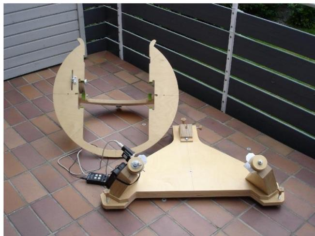
Abb. 4: Die Montierung ohne Werkzeug in 2 Teile zerlegt
